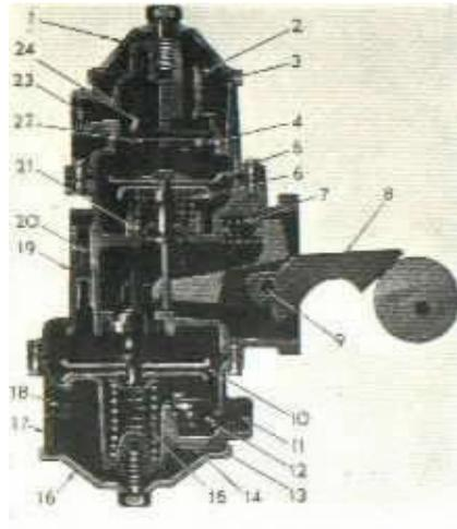
FIG. 13—FUEL AND VACUUM PUMP
