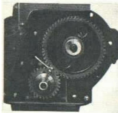
**FIG. 8—TIMING GEAR MARKS**
