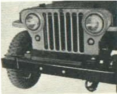
FIG. 37 —FRONT BUMPER WEIGHT
